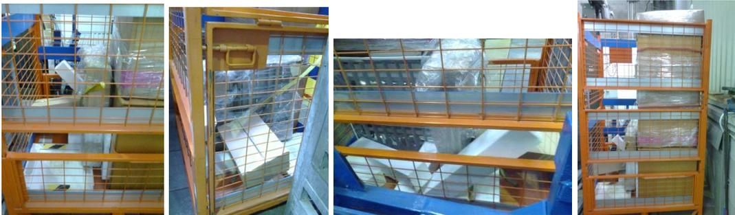
*Imágenes de la carga de la jaula tras ensayo de vibración vertical
