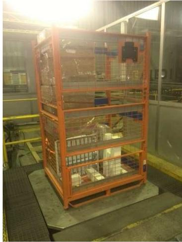
*Imagen de ensayo de vibración vertical
