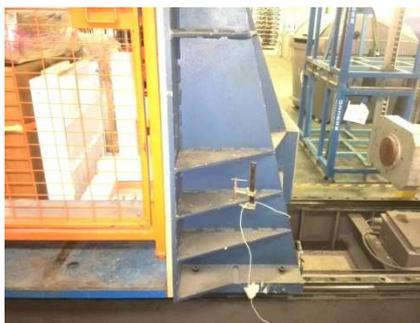
Imagen de ensayo de impacto horizontal
