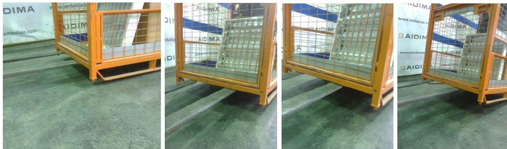
*Imágenes de ensayo de caída rotacional
